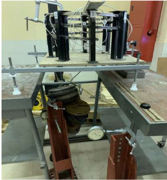
Рис. 7. Нагружение пролета № 3 до 120 кг
