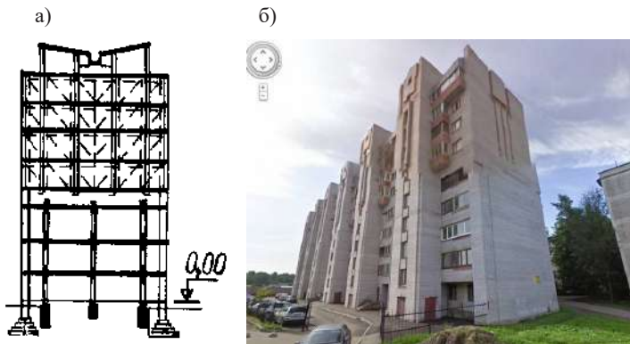
Рис. 3. Применение каркасной технологии при реконструкции панельного жилого дома массовой серии в Санкт-Петербурге: а – конструктивная схема каркаса; б – надстроенное здание
