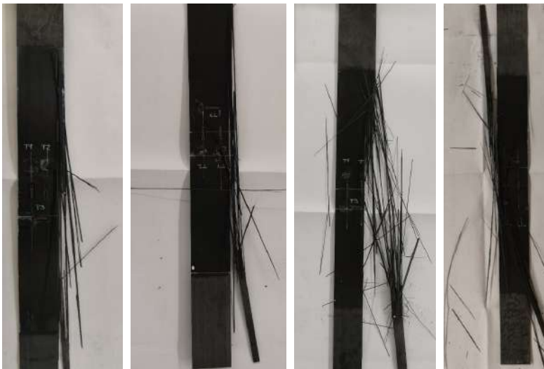
Рис. 8. Варианты разрушения образцов серии FRP-40 (2)
