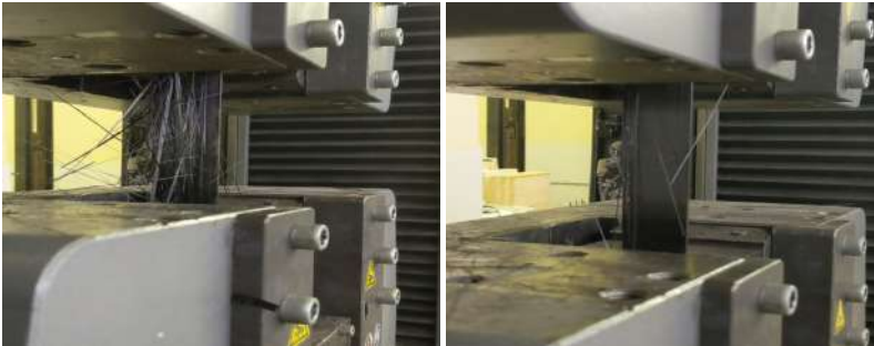
Рис. 7. Варианты разрушения образцов серии FRP-40 (1)
