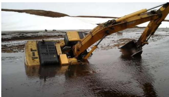
Рис. 4. Опрокидывание в воде
