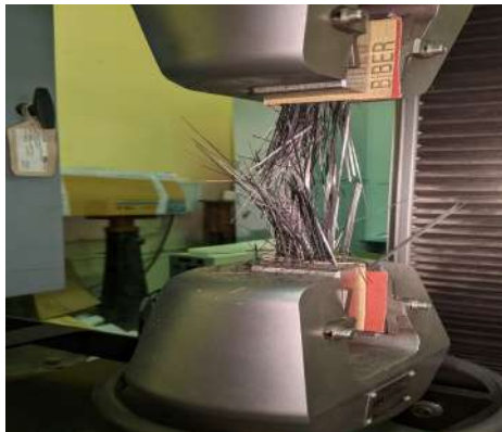
Рис. 6 Характерное разрушение образцов серии FRP-30
