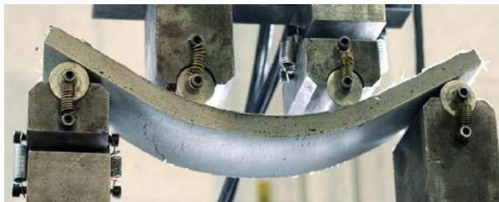
Рис. 3. Гибкий бетон ConFlexPave
