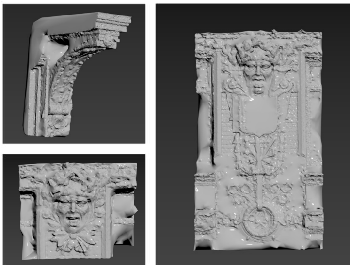
Рис. 7. Результаты лазерного сканирования декоративных частей фасадов здания
