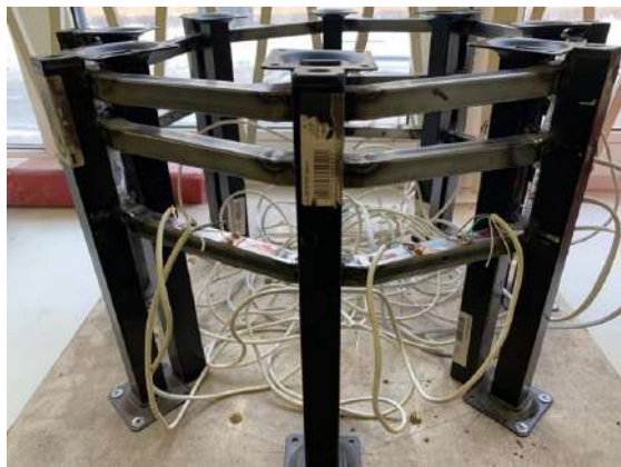
Рис. 6. Этап установки тензодатчиков на модель
