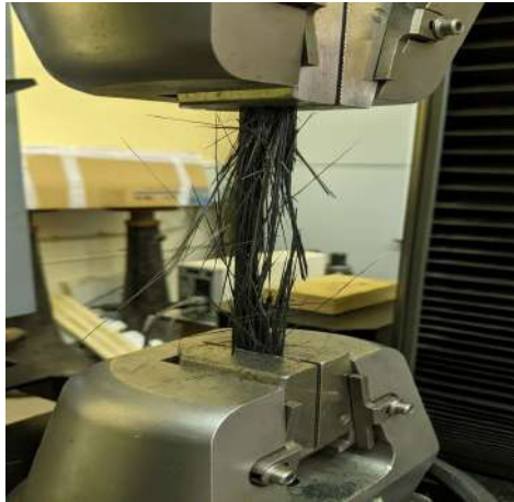
Рис. 5. Характерное разрушение образцов серии FRP-20
