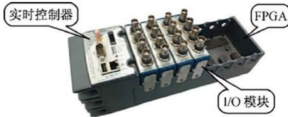
Рис. 5. Принципиальная схема системы сбора данных
