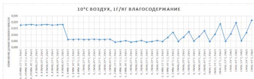
Рис. 8. Интенсивность изменения диаметра капели при t_b=10 °C, W_{\text{возд}}=1 г/кг
