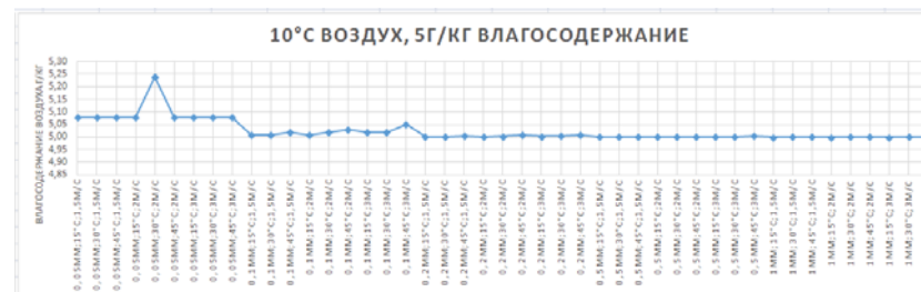
Рис. 5. Увлажнение воздуха при t_b=10 °С, W_{\text{возд}}=5 г/кг
