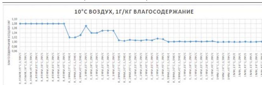
Рис. 7. Увлажнение воздуха при t_b=10 °C, W_{\text{возд}}=1 г/кг
