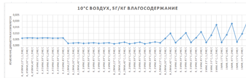
Рис. 6. Интенсивность изменения диаметра капель при t_b=10 °С, W_{\text{возд}}=5 г/кг
