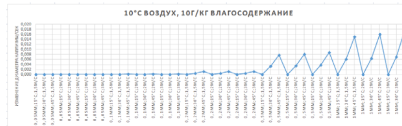
Рис. 4. Интенсивность изменения диаметра капель при t_b=10 °С, W_{\text{возд}}=10 г/кг
