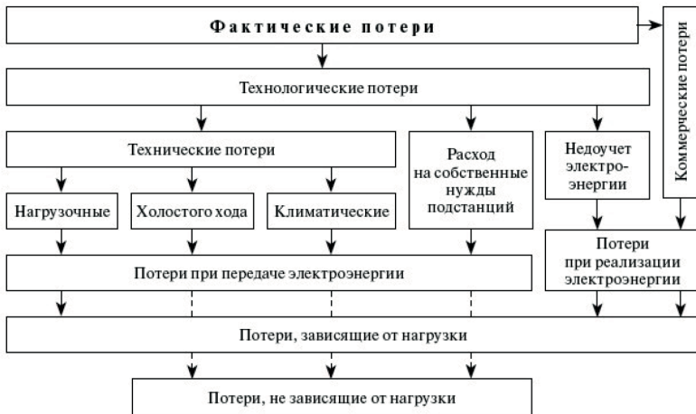
Рис. 1. Структурная схема фактических потерь
