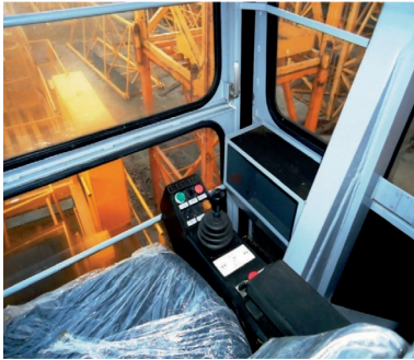
Рис 1. Реализация пульта управления в кабине машиниста башенного крана: а – командоконтроллер Liebherr 132EC-H8; б – силовой контроллер КБ-515
