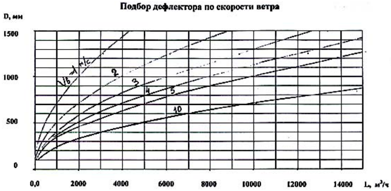
Рис. 4. График определения диаметра дефлектора от расхода и скорости ветра
