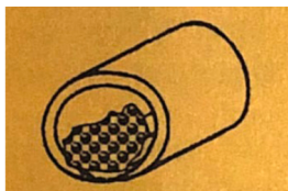
Рис. 5. Отложения жировых и солевых наносов
