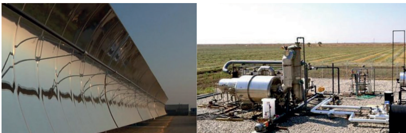
Рис. 4. Вид опреснительной установки Aqua4 на солнечной энергии
