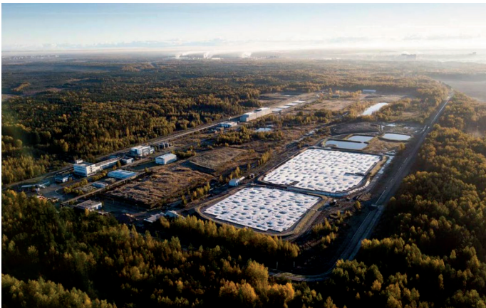
Рис. 3. Карты-котлованы с жидкими органическими отходами № 64 и № 68 накрыты понтонами
