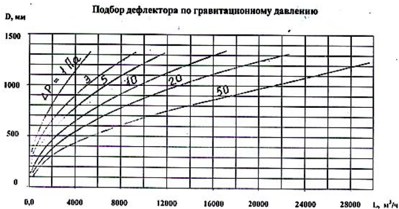
Рис. 6. График определения диаметра дефлектора в зависимости от расхода воздуха и гравитационного давления
