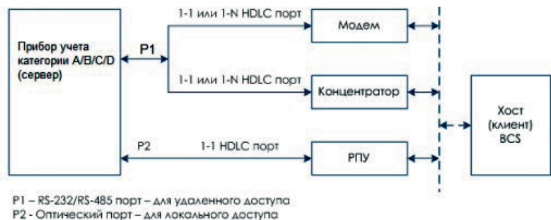
Рис. 2. Типовая схема соединения между сервером и клиентом
