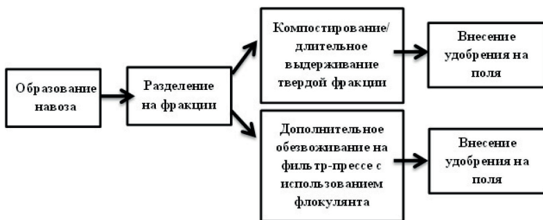
Рис. 2. Блок-схема технологии разделения навоза на фракции с дополнительным разделением жидкой фракции на фильтр-прессе с использованием флокулянтов и ускоренным компостированием твердых фракций и использованием осветленной жидкости на полях орошения или полях фильтрации
