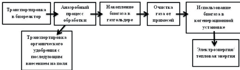
Рис. 3. Блок-схема технологии получения биогаза
