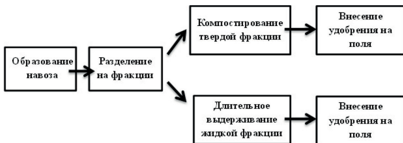
Рис. 1. Блок-схема технологии разделения на твердую и жидкую фракции с компостированием твердой фракции, длительным хранением жидкой фракции и внесением в почву
