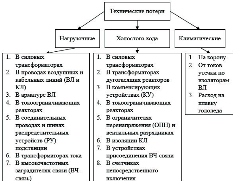
Рис. 2. Технические потери ЭЭ в сетях 0,4/10 кВ, структурная схема
