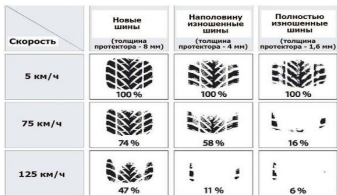
Рис. 1. Изменение пятна контакта шины с дорогой
