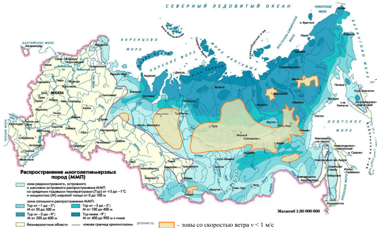
Рис. 1. Карта Российской Федерации с распространением по территории многолетнемерзлых пород и зоны с малой скоростью ветра
