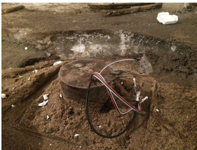
Рис. 7. Комплект полевого измерения температуры грунтов
