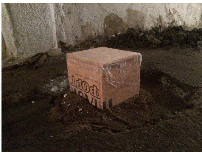
Рис. 6. Термометрическая скважина накрытая коробом
