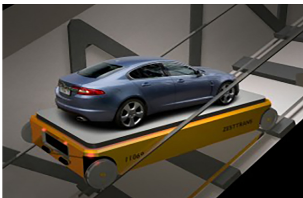
Рис. 6.11. Подъем автомобиля на платформе “TRAM-Zest”
