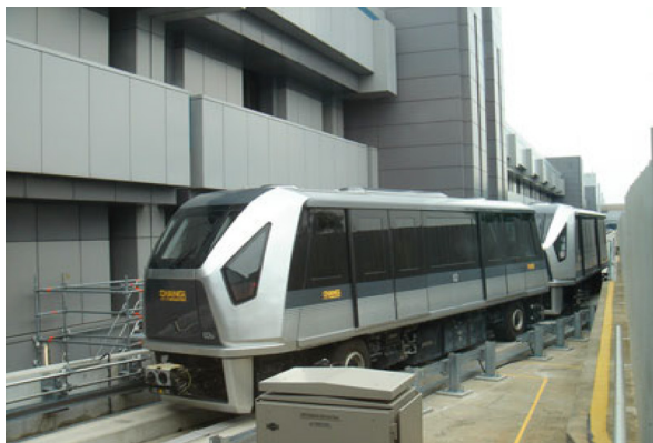
Рис. 6.14. Автоматизированная транспортная система Crystal Mover от Mitsubishi
