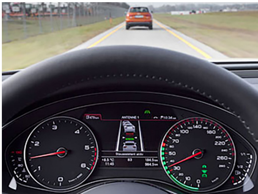
Рис. 5.8. Работа системы Traffic Jam Assist
