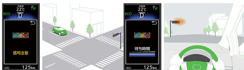
Рис. 5.3. Взаимодействие системы ITS Connect со светофором, оборудованным передатчиком ITS (V2I)
