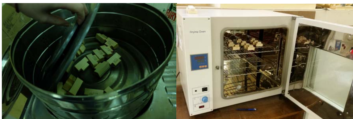
Рис. 2. Вымачивание и высушивание образцов
