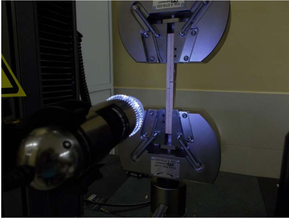
Рис. 6. Испытания образцов на определение предела прочности клеевых соединений при растяжении вдоль волокон
