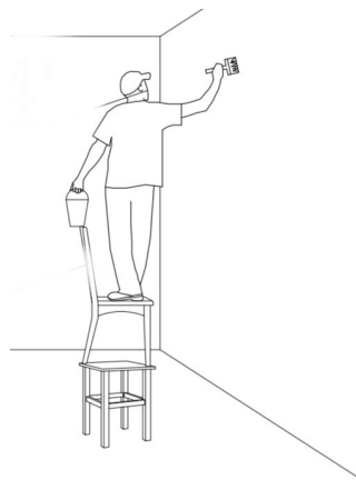
Рис. 3. Инсталляция малярных работ без средств подмащивания
