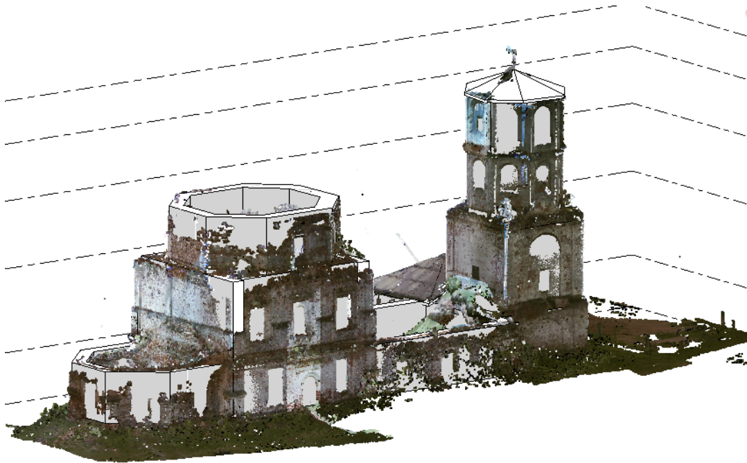
Рис. 8. Возведение общей геометрии согласно облаку точек
