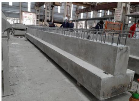
Рис. 5.6. Т-образная балка из ВПЛБ с пролётом 12 000 мм
