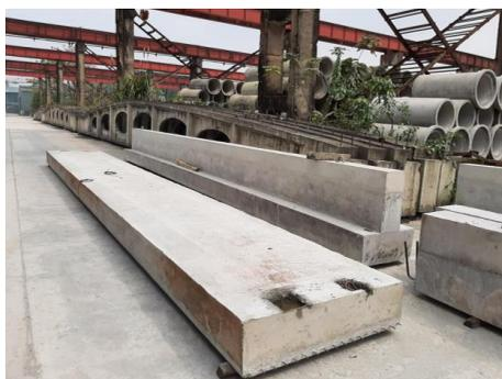
Рис. 5.7. Плита перекрытия из ВПЛБ размером 12 000x1000 мм
