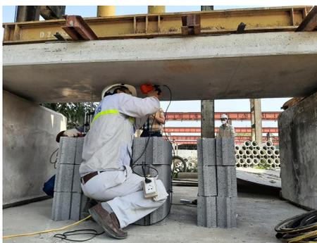
Рис. 5.8. Испытания плиты перекрытия из ВПЛБ (3280x800x140 мм)
