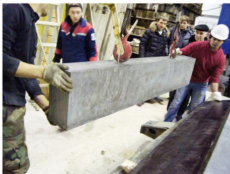
Рис. 5.5. Распалубка готовых изделий из высокопрочного лёгкого бетона
