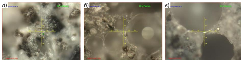
Рис. 3.27. Микрофотографии исследованных методом КР-спектроскопии областей (показано зелёным цветом) для цементного камня (а), границы раздела фаз в композите с микросферами (б) и наномодифицированными микросферами (в)
