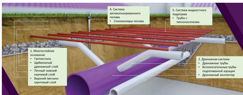
Рис. 3. Инженерные системы футбольного поля
