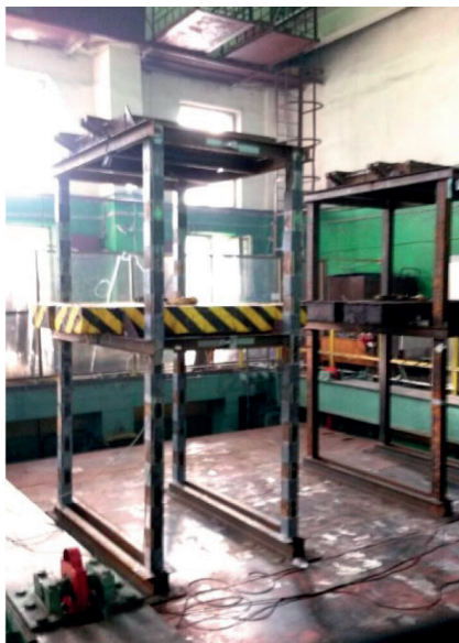
Рис. 3. Усиленный и неусиленный образцы, закрепленные на сейсмостенде перед испытаниями
