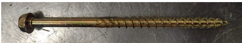
Рис. 4. Саморез с неполной резьбой, применяемый для образца с ориентацией нечетных слоев поперек образующей
