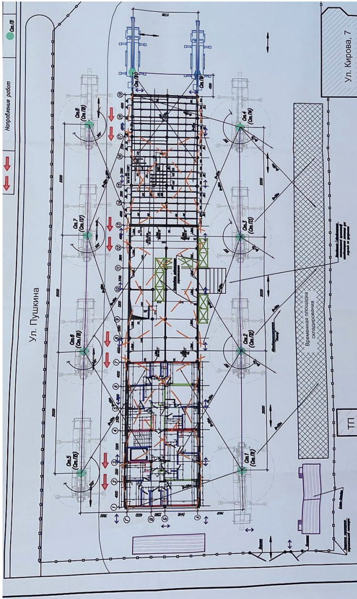
Рис. 4. План первого этажа с указанием стоянок самоходного крана в процессе монтажа
