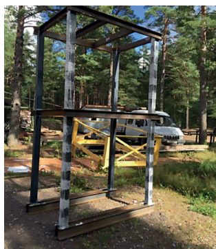
Рис. 2. Опытный образец, усиленный однонаправленными углеродными лентами
