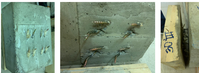
Рис. 7. Деформация саморезов, установленных под углами 60, 45 и 30 градусов соответственно
