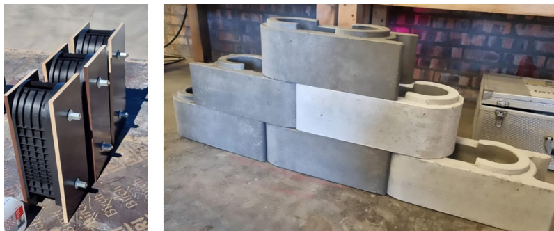
Изготовление блоков по технологии TwistBlock Moulds
