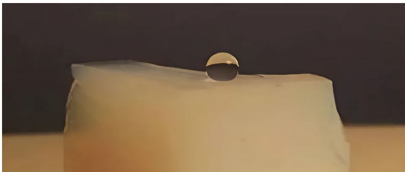
Рис. 3. Капля воды диаметром 2,5 мм на поверхности аэрогеля
