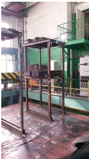
Рис. 8. Монтаж образца на стенде
