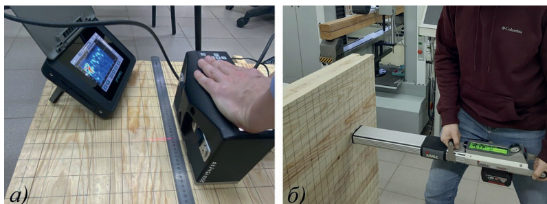
Рис. 3. Проведение измерений при неразрушающем контроле плит из ДПК: а – эхоимпульсным акустическим методом, ультразвуковым прибором Pundit 250 Array; б – методом измерения сопротивления сверлению устройством IML-RESI PD 400
